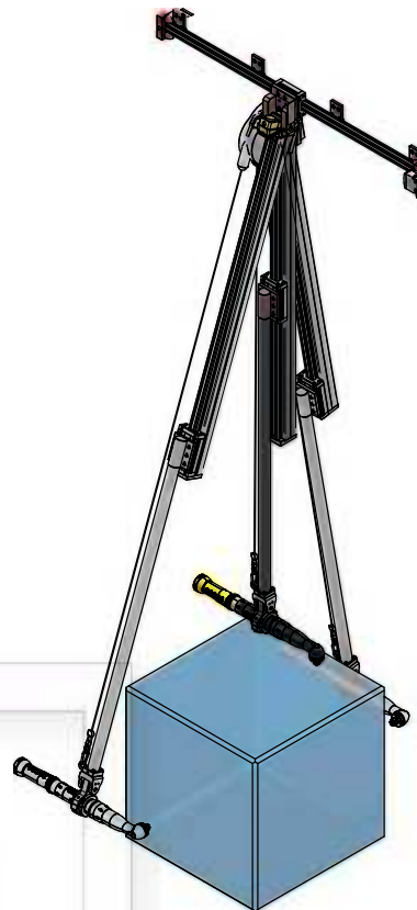
SLIDER 50 kompaktowy komputer PC z systemem pozycjonowania + kodery laserowe na szynie poziomej
