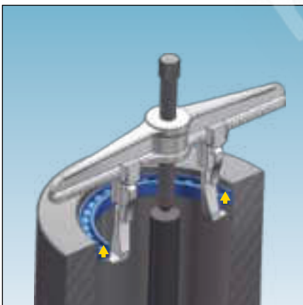
Ściągacze serii HAZET nr 1787 F 9-35 · 1787-52 · 1787 S-1 i 2 · 1783-22 mogą być stosowane również jako ściągacze wewnętrzne poprzez prosty obrót haków ściągających na poprzeczce. Warunkiem jest wał na środku części oparty na wrzecionie.
