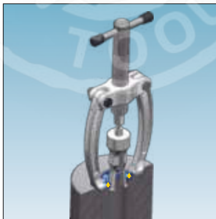
Standardowo przy takim zastosowaniu pracuje się ze ściągaczem wewnętrznym i ściągaczem jarmowym.
